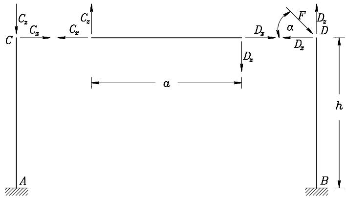
Najprej napišemo ravnotežne enačbe. Dobimo  $C_z = D_z = 0$ ,  $C_x = D_x = N$ , kjer smo z  $N$  označili neznano osno silo v palici  $CD$ . Osno silo  $N$  lahko izračunamo iz pogoja, da bo horizontalni pomik vozlišča  $D$  enak horizontalnemu pomiku vozlišča  $C$  in raztezku palice  $CD$ . Z uporabo tabel dobimo
