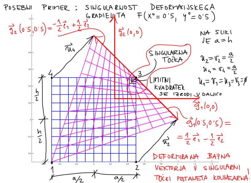
Slika 6: Singularen deformacijski gradient
