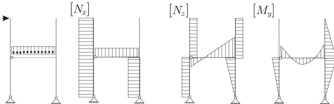
2. Za konstrukcijo na sliki izračunajte stopnjo statične nedoločenosti, reakcije in notranje statične količine ( $N_x, N_z, M_y$ )! Rezultate notranjih statičnih količin prikažite z diagrami!
