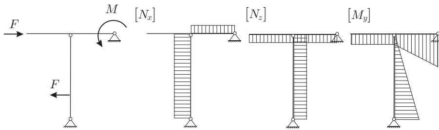
2. Za konstrukcijo na sliki izračunajte stopnjo statične nedoločenosti, reakcije in notranje statične količine ( $N_x, N_z, M_y$ )! Rezultate notranjih statičnih količin prikažite z diagrami! (OBVEZNA NALOGA! 50%)
