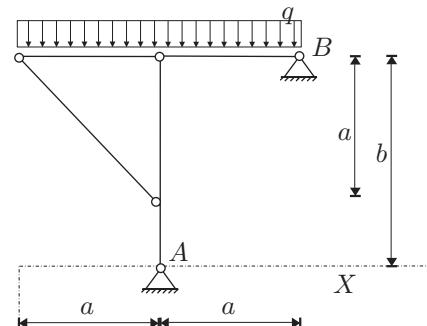
3. Za palično konstrukcijo na sliki izračunajte stopnjo statične nedoločenosti in osne sile v palicah 1, 2 in 3! (25%)
