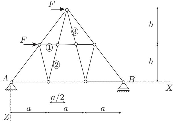
3. Za konstrukcijo na sliki izračunajte stopnjo statične nedoločenosti, reakcije in notranje statične količine ( $N_x, N_z, M_y$ )! Rezultate notranjih statičnih količin prikažite z diagrami!
