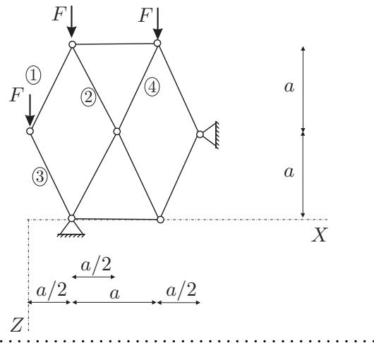
3. Za konstrukcijo na sliki določite reakcije v podporah in sile v vezeh. (30%)
