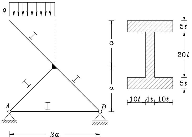
**2.** Za simetrični tankostenski prečni prerez na sliki izračunaj:
