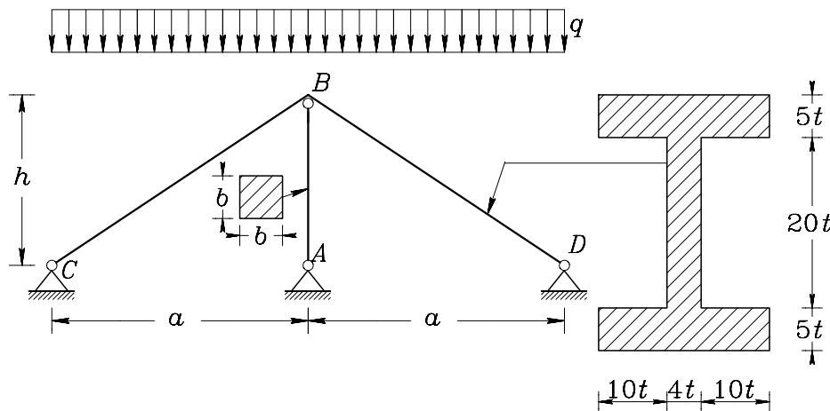
2. Ravninski mreža je obremenjena z navpično silo  $F$ . Vsi nosilci imajo enak prerez, kakršen je prikazan na sliki. Izračunaj upogibni in torzijski vztrajnostni moment prereza. Izračunaj notranje sile in nariši diagrame notranjih sil.
