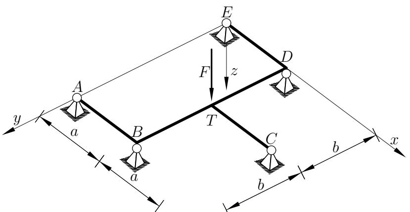
1. Konstrukcija je enkrat statično nedoločena. Diagrame notranjih sil prikazuje spodnja slika.
