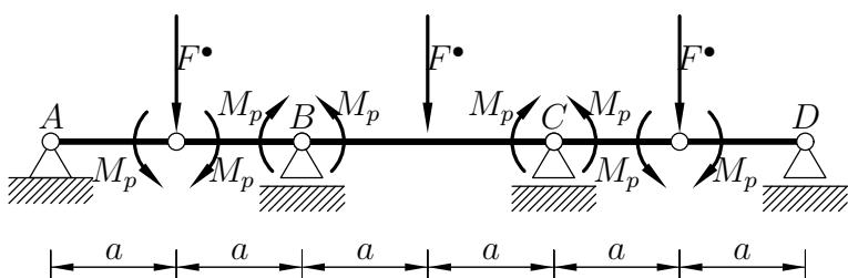
3. Konstrukcija na sliki je dvakrat statično nedoločena (vse vodoravne reakcije so enake nič). Reševanje lahko poenostavimo z upoštevajem simetrije. Diagrame notranjih sil prikazuje spodnja slika.
