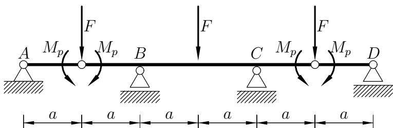
Gornja konstrukcija je statično določena. Z uporabo statike določimo diagrame upogibnih momentov. Največja upogibna momenta se pojavita nad podporama  $B$  in  $C$ . Vrednosti teh momentov izenačimo z  $-M_p$  in od tu izračunamo porušno obtežbo  $F^*$ . Dobimo  $F^* = \text{kN}$ . Porušni mehanizem je prikazan na spodnji sliki.
