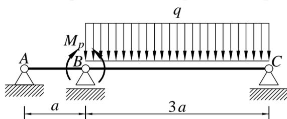
3. Konstrukcija je enkrat statično nedoločena. Diagrame notranjih sil prikazuje spodnja slika.
