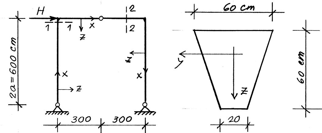
2. Enakomerno debela toga homogena plošča teže  $G$  je togo pritrjena na dva vodoravna nosilca. Določi zasuk plošče v ravniini ( $x, z$ )!
