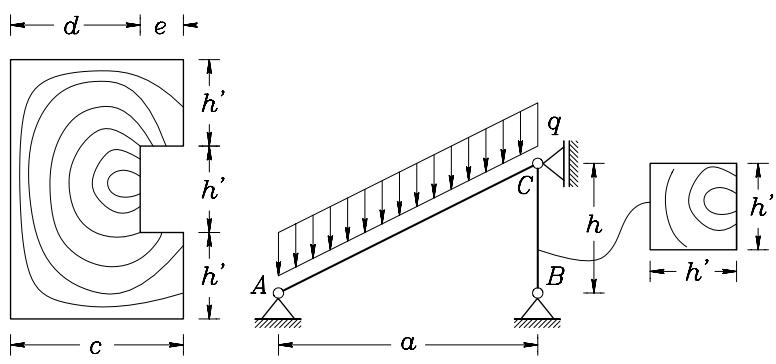
2. Jeklen ravninski okvir konstantega prereza enakomerno ohladimo za  $\Delta T = -30$  K. Izračunaj notranje sile in nariši diagrame notranih sil.
