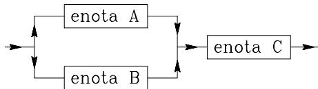
Dejanske pretoke označimo z  $m_A$ ,  $m_B$  in  $m_C$ , izmerjeni pretoki pa so slučajne spremenljivke  $X_A$ ,  $X_B$  in  $X_C$  s srednjimi vrednostmi  $m_A$ ,  $m_B$  in  $m_C$  in enakimi standardnimi deviacijami  $\sigma_A = \sigma_B = \sigma_C = \sigma$ . Predpostavimo, da sistem cevi na obravnavanem delu ne pušča. To pomeni, da je  $m_A + m_B = m_C$ . Po metodi najmanjših kvadratov lahko ugotovimo, da je najboljša ocena za pretok skozi enoto A enaka
