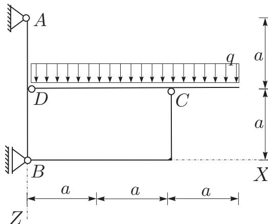
3. Za palično konstrukcijo na sliki izračunajte stopnjo statične nedoločenosti, reakcije in osne sile v označenih palicah!
