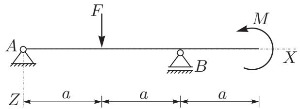
2. OBVEZNA NALOGA Za konstrukcijo na sliki izračunajte stopnjo statične nedoločenosti, reakcije in notranje statične količine ( $N_x, N_z, M_y$ )! Rezultate notranjih statičnih količin prikažite z diagrami! (50%)
