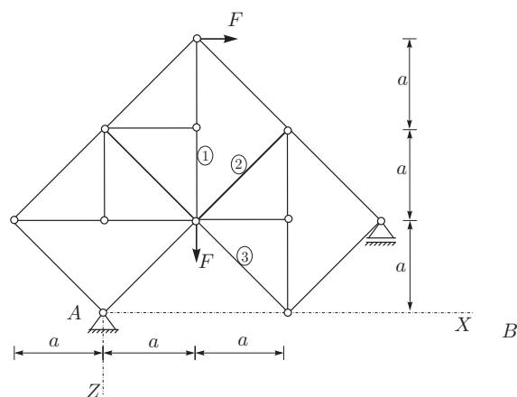
4. Za konstrukcijo na sliki preverite, če je statično določena! Zapišite ustrezne enačbe in odgovor utemeljite. (20%)
