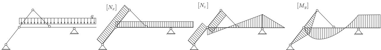
3. Za palično konstrukcijo na sliki izračunajte stopnjo statične nedoločenosti, reakcije in osne sile v označenih palicah! (20%)
