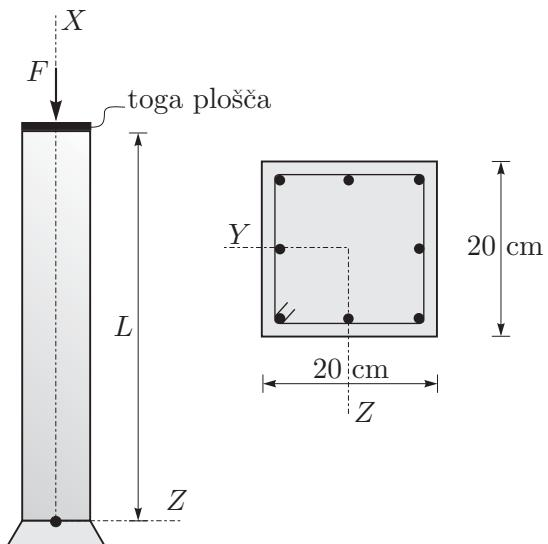
**Rešitev:** Tlačno silo, s katero je obtežen steber, uravnotežata resultantna sila betonskega dela stebra  $F_b$  in resultantna sila armaturnih palic  $F_j$ :
