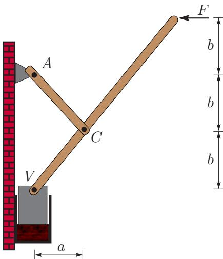
**Rešitev:** Stiskalno napravo razstavimo na elemente in njihove medsebojne vplive nadomestimo z ustreznimi silami, kot kaže slika.
