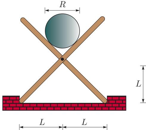
**Rešitev:** Medsebojni vpliv med valjem in nosilcem nadomestimo z enakima silama  $N$ , ki sta pravokotni na osi nosilcev. Vpliv podlage nadomestimo z reakcijami v točkah  $A$  in  $B$ . Za določitev sil v vezih dodatno ločimo nosilca in vez  $V$  in zapišemo ravnotežne enačbe na enem izmed nosilcev.
