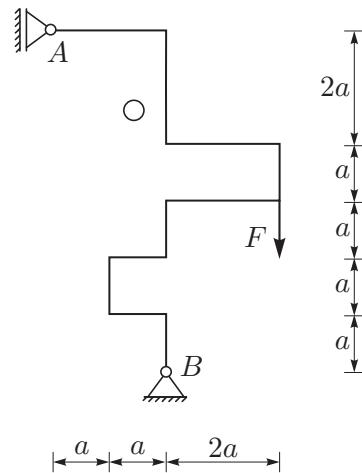
**Rešitev:** Podpori odstranimo in njun vpliv nadomestimo z reakcijami. Reakcije so:  $A_X = -\frac{F}{3}$ ,  $B_X = -\frac{F}{3}$ ,  $B_Z = -F$ . Reševanje naloge zahteva zadostno mero vztrajnosti in potrežljivosti. Konstrukcijo razdelimo na 10 polj in za vsako polje zapišemo momentni ravnotežni pogoj glede na prerezno točko. Diagramme upogibnih momentov prikazujemo na spodnji sliki.
