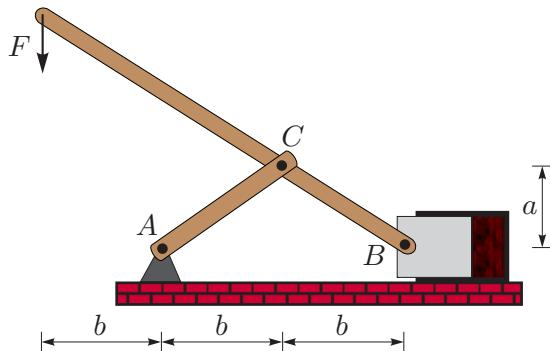
**Rešitev:** Stiskalno napravo ustrezno ločimo na elemente in medsebojne vplive nadomestimo z ustreznimi silami, kot kaže slika.
