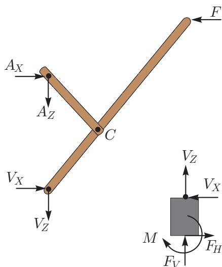
Opozorimo, da naloga zahteva le določitev navpične sile, s katero deluje naprava na stiskano telo. Ta je seveda nasprotno enaka sili, s katero telo deluje na stiskalni bat. Na sliki smo to silo označili z  $F_V$ . Iz ravnotežja sil v navpični smeri sledi  $F_V = -V_Z$ . Določiti je torej potrebno navpično silo v vezi  $V$ . Za sistem dveh
