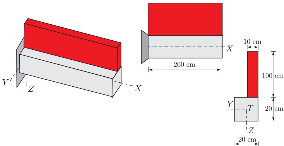
**Rešitev:** Ker nosilec modeliramo z linijskim elementom, ki ga določa os, moramo na os nosilca reducirati tudi obtežbo. To je shematsko prikazano na spodnji sliki.
