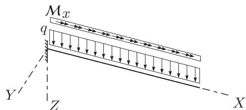
Obtežbo na os nosilca predstavljata enakomerna porazdeljena obtežba  $q$  v smeri osi  $Z$ , zaradi ekscentričnosti zidu pa še enakomerni torzijski moment  $M_x$ . Obe statično enakovredni obtežbi določimo na osnovi podatkov o zidu:
