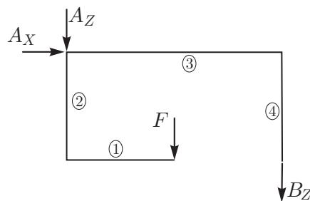
Reakcije so:  $A_X = 0$ ,  $A_Z = B_Z = -50 \text{ N}$ . Konstrukcijo razdelimo na polja in za vsako polje iz ravnotežnih enačb določimo notranje sile. Diagrame prikazujemo na spodnji sliki.
