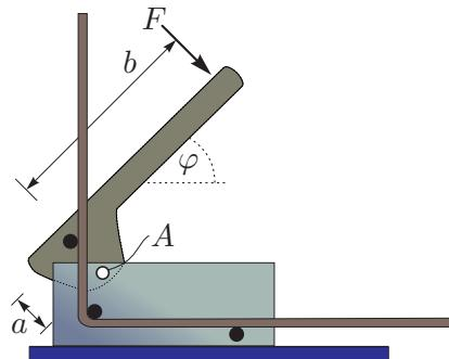
**Rešitev:** Obravnavamo ročico naprave, vpliv armaturne palice in osi  $A$  pa nadomestimo z silami, kot kaže slika ( $a_1 = \frac{\sqrt{2}}{2}a$ )
