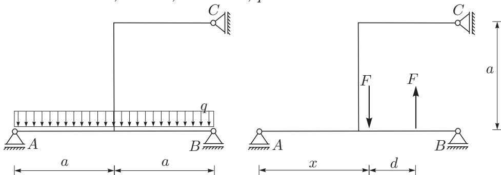
**Rešitev:** Notranje sile v zgornjem delu okvirja so enake nič, saj je reakcija v podpori  $C$  za dana obtežna primera enaka nič. Torej lahko obravnavamo le prostoležeči nosilec  $AB$ , ki je obtežen z enakomerno prečno linijsko obtežbo in dvojico sil. Momente zaradi porazdeljene obtežbe izrazimo kot funkcijo oddaljenosti od leve podpore:
