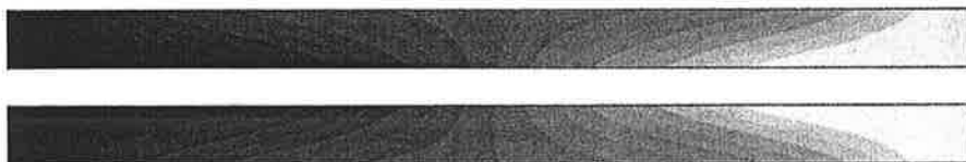
Slika 7: Tlačno polje v srednji legi merilne cevi ( V = 2 \text{ m/s} , fr = 80 \text{ Hz} ). Črno-bela linearna lestvica predstavlja razpon od 700 Pa (belo) do 1400 Pa (črno)
