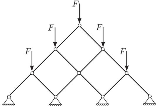
Vzemimo, da ima paličje  $n$  etaž (namesto treh v prikazanem paličju). Poišči najbolj obremenjeno palico v tako povečanem paličju in določi osno silo v njej!
