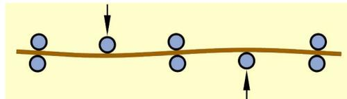
Določi reakciji v drugih dveh podporah ter določi in nariši diagrame notranjih sil v preizkušancu! Sili, s katerima premična valja obtežita preizkušanec, znašata  $F = 0.1 \text{ kN}$ .
