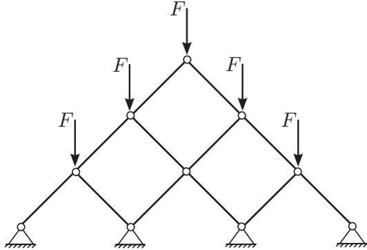
**Rešitev:** Izrežemo vozlišča paličja in rešujemo ravnotežne enačbe v vozliščih od vrha paličja navzdol proti podporam. Posamezne palice označimo z  $N_{ij}$ , pri čemer prvi indeks pomeni nivo palic, drugi indeks pa horizontalno zaporedje palic. Pri označevanju upoštevamo še simetrijo. Izrezana vozlišča z vsemi silami so predstavljena na spodnji sliki.
