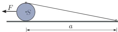
V vodoravni smeri povlečemo valj s silo  $F$ . Kolikšna sila je potrebna, da premaknemo valj? Masa valja je 10 kg. Vodoravna razdalja med težiščem valja  $S$ , na katerega deluje sila  $F$ , in pritrdiščem vrvi je  $a = 1\text{ m}$ .
