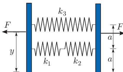
**Rešitev:** Prerežimo vzmeti ob levi plošči in odrezane vzmeti nadomestimo z ustreznimi silami, kot kaže slika.
