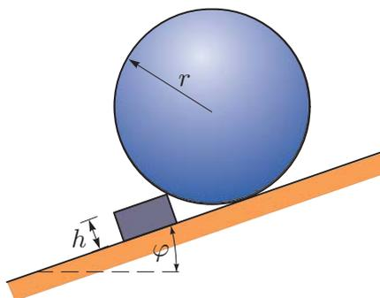
**Rešitev:** Krogla se prekotali preko ovire, ko ima težišče nad dotikališčem z oviro. Iščemo torej tak kot  $\varphi$ , da težišče krogle in dotikališče ležita na skupni navpični premici.
