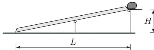
Določi koeficient trenja  $k_t$  pri ravnem vodnem toboganu z vodoravno dolžino  $L = 10$  m in višino  $H = 4$  m! Začetna hitrost vreče je enaka nič, čas drsenja pa 4 sekunde. Pri določitvi koeficienta trenja predpostavimo, da je gibanje vreče enakomerno pospešeno. V tem primeru gibanje vreče določata enačbi  $F = ma$  in  $S = at^2/2$ , kjer  $m$  označuje maso,  $a$  je pospešek,  $F$  je rezultanta sil v smeri gibanja,  $S$  je pot in  $t$  čas gibanja.
