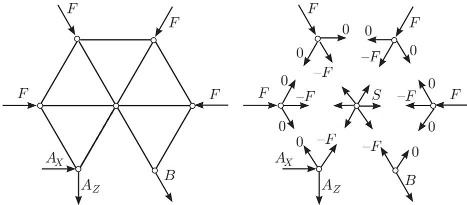
Osne sile v palicah določamo postopoma z ravnotežnimi enačbami vozlišč. Najprej analiziramo vozlišče  $B$ . Reakcija podpore je vzporedna eni palici, zato je sila v drugi palici enaka nič. Postopek nadaljujemo po vozliščih na obodu v nasprotni smeri urinega kazalca. Tako ugotovimo, da so vse osne sile v palicah na obodu enake nič, osne sile v palicah, ki povezujejo srednje vozlišče  $S$  z obodom pa  $-F$ .
