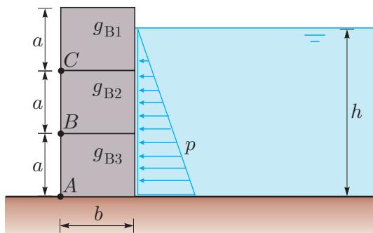
**Rešitev:** Obravnavamo tri sisteme teles: zgornji blok, zgornji in srednji blok ter vse tri bloke skupaj. Obravnavane sisteme, skupaj s silami, ki nanje delujejo, prikazujemo na sliki.
