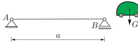
**Rešitev:** Medsebojni vpliv med konstrukcijo in vozilom opišemo z enako velikimi, nasprotno usmerjenimi silami, kot prikazujemo na sliki.
