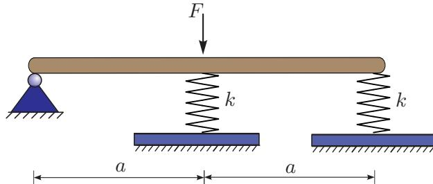
**Rešitev:** Podporo in vzmeti odstranimo. Njihov vpliv na konstrukcijo nadomeščimo z ustreznimi silami, kot kaže slika
