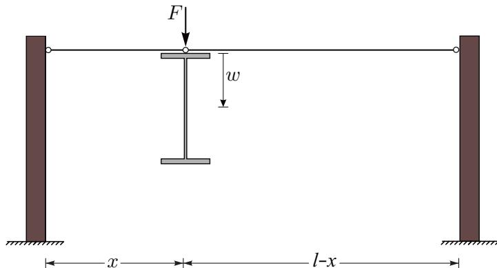
Jekleni vrvi imata premer  $d = 5 \text{ mm}$  in elastični modul  $E = 19500 \text{ kN/cm}^2$ ; razdalja med togima stebroma je  $l = 300 \text{ cm}$ . Predpostavimo, da sta stebra tako toga, da je njuno deformiranje zanemarljivo, zato se vpetišče vrvi ne premakne.
