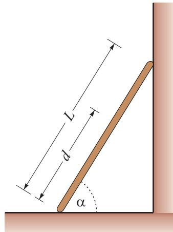
**Rešitev:** Tla in steno odstranimo, njun vpliv pa nadomestimo s silami  $N_A$ ,  $T_A$  in  $N_B$ , kot je prikazano na spodnji desni sliki. Za boljšo geometrijsko predstavo najprej izračunajmo razdalji  $a$  in  $b$ :
