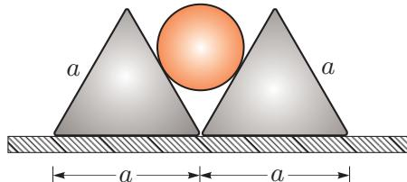
**Rešitev:** Sistem razstavimo na tri podsisteme, medsebojne vplive ter vpliv podlage pa nadomestimo z ustreznimi silami, kot kaže slika. Ravnotežnje sil zapišemo za valj in za levo prizmo:
