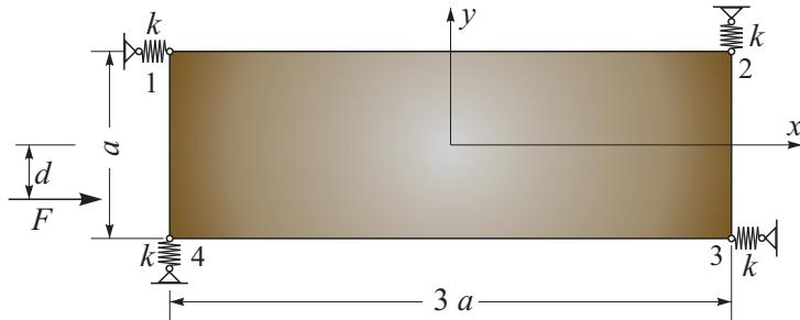
**Rešitev:** Podpore z vzmetmi odstranimo in jih nadomestimo s silami  $F_1$ ,  $F_2$ ,  $F_3$  in  $F_4$ , kot je prikazano na spodnji sliki. Velikost teh sil je odvisna od skrčka oziroma raztezka  $\Delta u_i$  vzmeti, ki so po absolutni vrednosti enake pomikom teh štirih točk v smereh vzmeti:
