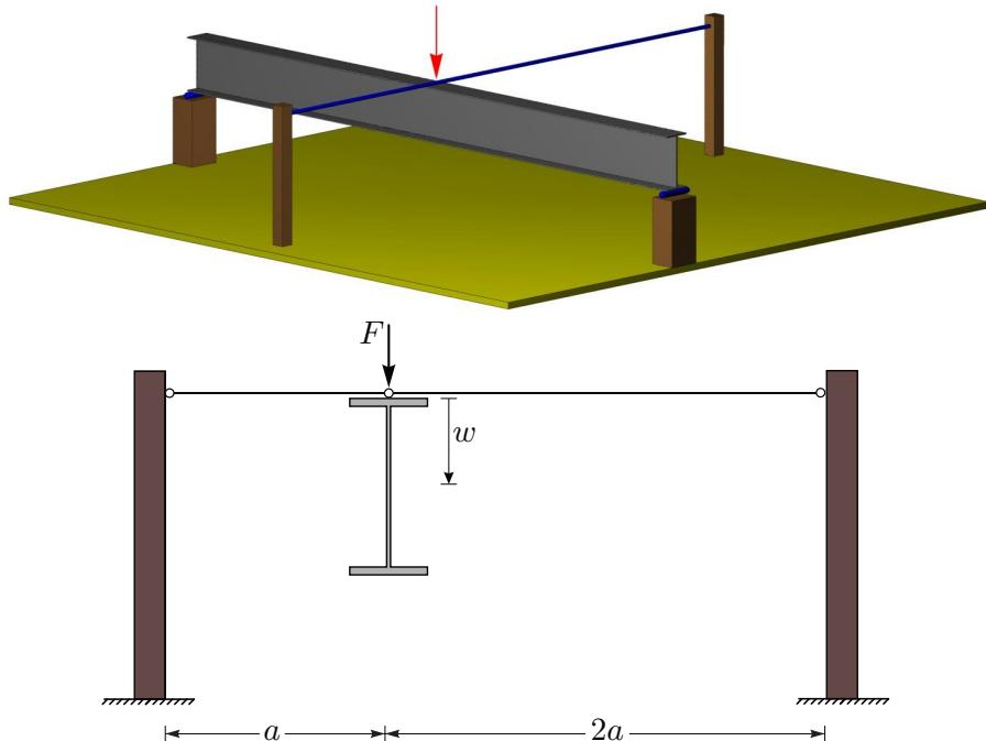
Jekleni vrvi imata premer  $d = 6 \text{ mm}$  in elastični modul  $E = 19500 \text{ kN/cm}^2$ , razdalja  $a = 100 \text{ cm}$ . Predpostavimo, da sta stebra tako toga, da je njuno deformiranje zanemarljivo, zato se vpetišče vrvi ne premakne.
