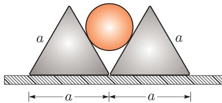
**Rešitev:** Sistem razstavimo na tri podsisteme, medsebojne vplive ter vpliv podlage pa nadomestimo z ustreznimi silami, kot kaže slika. Ravnotežje sil zapišemo za valj in za levo prizmo:
