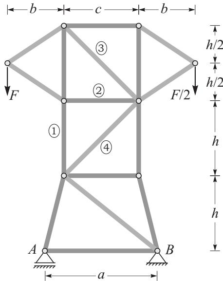
**Rešitev:** Konstrukcijo razrežemo preko palic, za katere želimo izračunati notranje sile. Na mestu prereza predpostavimo natezne osne sile v palicah, kot je prikazano na spodnji sliki.
