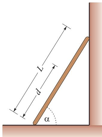
**Rešitev:** Tla in steno odstranimo, njun vpliv pa nadomestimo s silami  $N_A$ ,  $T_A$ ,  $N_B$  in  $T_B$ , kot je prikazano na spodnji desni sliki. Za boljšo geometrijsko predstavo najprej izračunajmo razdalji  $a$  in  $b$ :
